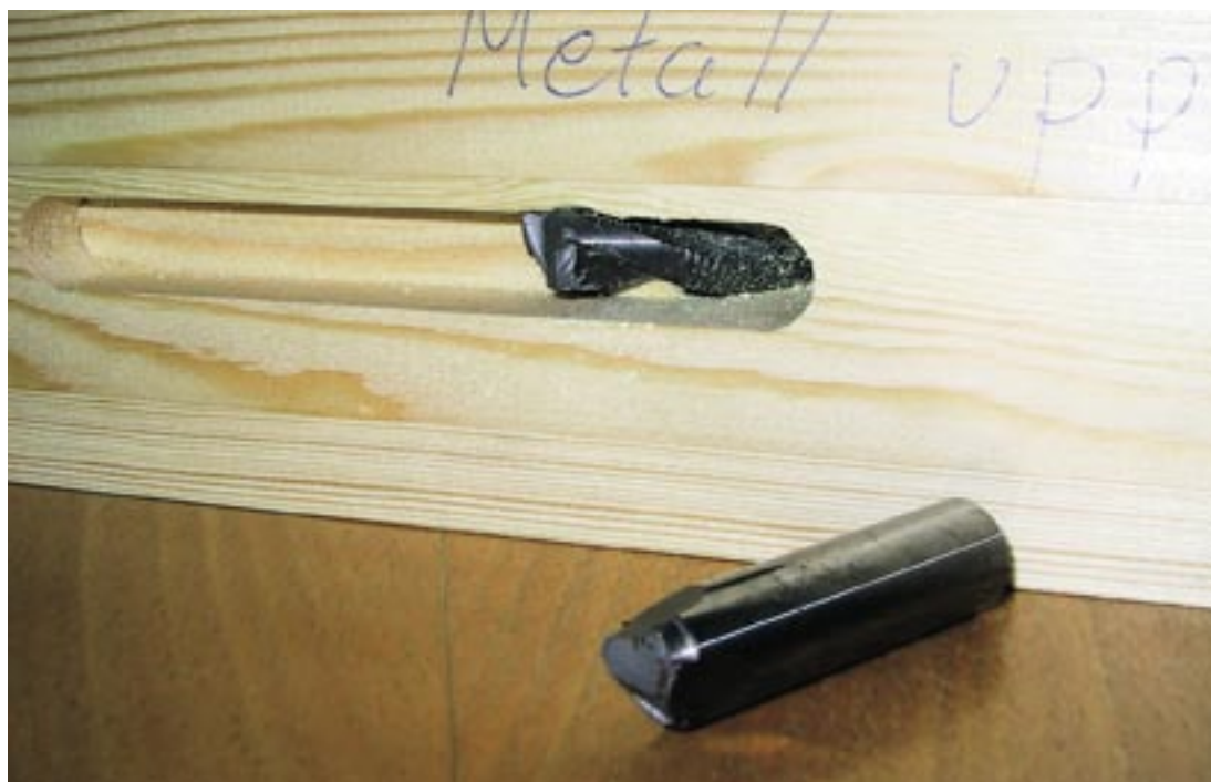
METALLFYND. Här är resterna av en trasig pinnfräs som upptäcktes av detektorn. Om den inte hade stoppats hade minst fyra verktyg havererat. Bara verktygen hade kostat över 60 000 kronor att ersätta.
